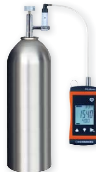
kalibrace zkušebním plynem
